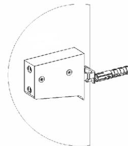
3. Прикрепите умывальник к стене с помощью винтов для крепления керамических умывальников. При монтаже напольных тумб на регулируемых опорах умывальник также требует обязательного крепления к стене. При необходимости отрегулируйте положение тумбы относительно умывальника с помощью регулирующих опор.
